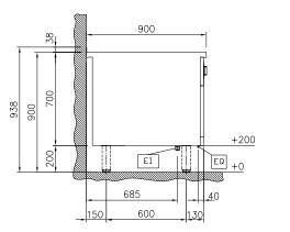
Electrical inlet (power) Equipotential screw
